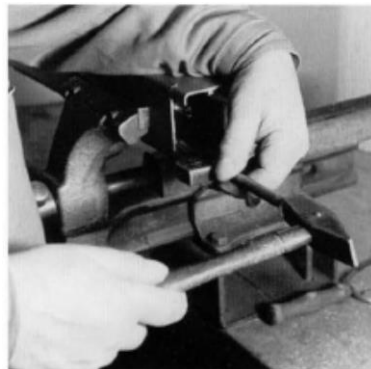
▶ 銅導体を内側成形ツールで成形します。
