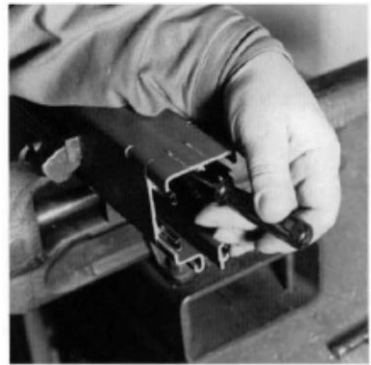
▶ PVC ハウジングから銅導体を 40-50mm の長さまで持上げます。
