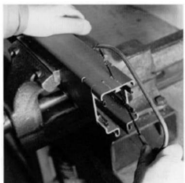
▶ 銅のサポートの両側の PVC ハウジングを 26mm のところまでのこぎりで切断します。
