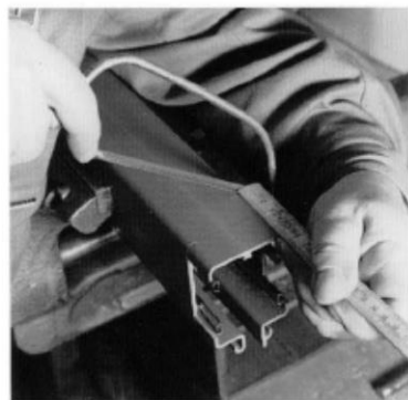
▶ 左右両側の端末から 50mm の上側角に印をつけます。
