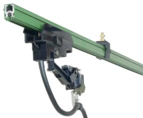
各極ごと(ユニポール)に導体を接触防止用絶縁ハウジングに収めたコンダクターシステム。必要な極数(導体数)を平行に並べて配置できます。曲げ、切り換え、断路区画の対応も可能です。
