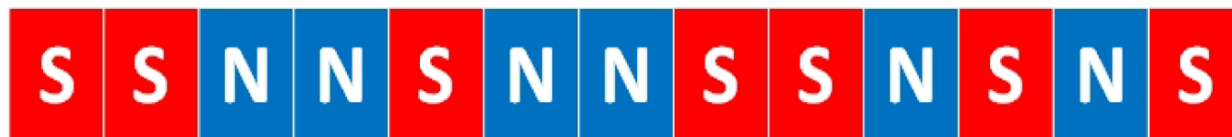
図 6-1 磁気ストリップのコーディング概略図
