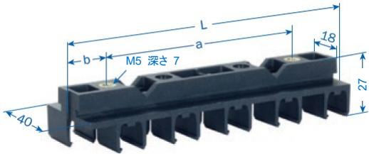
コンパクトハンガー背面に2つのM5インサートがあります。EMSの取付型鋼または他の取付型鋼に、できれば穴あけ治具(供給されません)を使用してM5の貫通穴を開け、コンパクトハンガーをボルトで取付けます。取付型鋼の厚みが指定されている場合はねじ部材を供給します。
