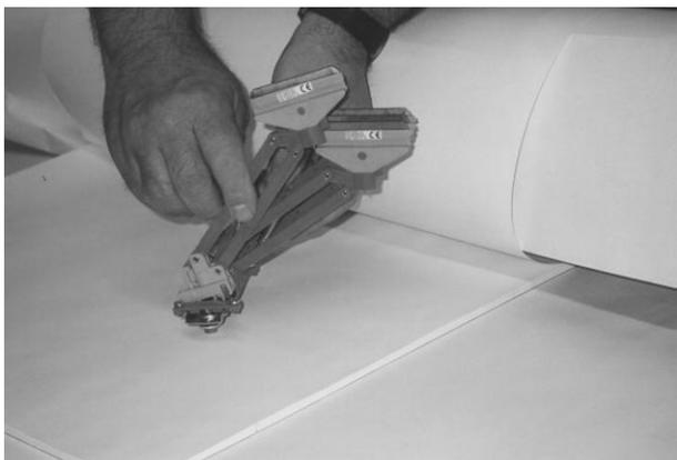
プラスチック取付ユニットを鋼製保持部品に取付けるためには後ろのプラスチックの舌部を鋼製の縁に止めて前方向にしっかりとパチッと入るまで回転させます。
