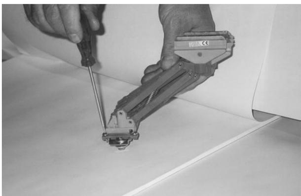
取付ユニットに集電子を取付けまたは取外するには集電子を横方向に 30°押し下げ中央まで回転させ、ケーブルを取付けユニットの穴に通します。両側の赤のプラスチック保持ストラップをねじ止めます。これで横方向のずれを防ぎます。接地用集電子は安全のため高くなっています。ケーブルは自由に動きねじれたり引張りすぎたりしないようにしてください。
