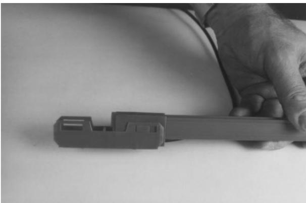
組立てた給電接続部をハウジングの摺動穴にはめ込みます。
