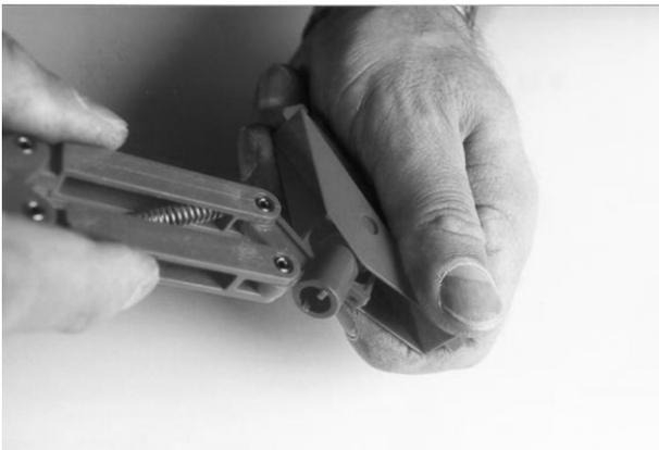
ヘッドの取外しのためにはヘッドを下側に押して外側に素早い動作で回転させます。
