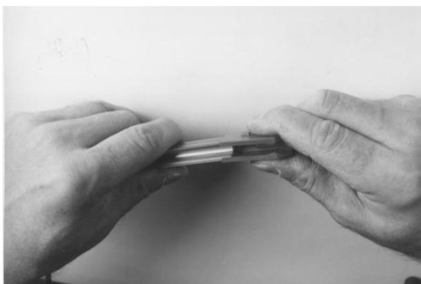
キャップの縁をスリーブの溝に揃えるように押込み、接触面とまっすぐになるようにバリを取ります。
