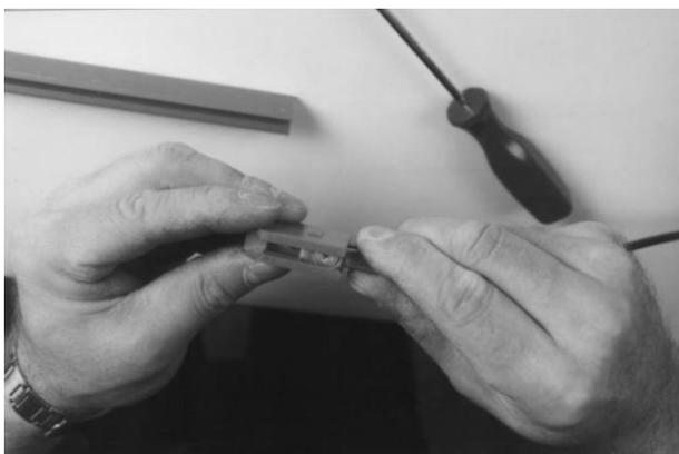
給電ケーブルの圧着端子を給電クランプのナットの下に接続を緩めたまま取付けます。クランプをトランスファーガイドの中に正面から奥にロックされるまで挿入します。
