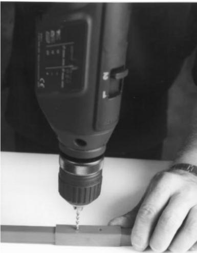
テンプレートとしてハウジングの開いている穴から銅の上の層までのみ穴あけ(3mmドリル使用)します。
