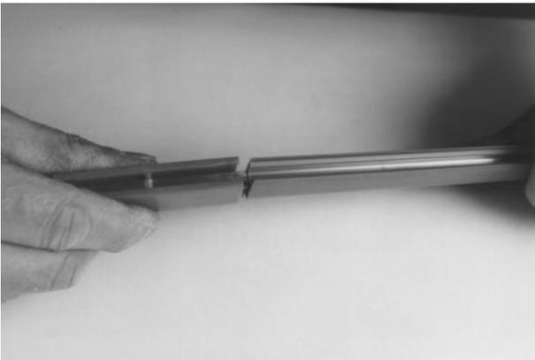
端末をバリ取りした2つのコンダクターレールを使用します。コンダクターレールをハウジングの中に中央のストッパーに当たるまでスライドさせます。
