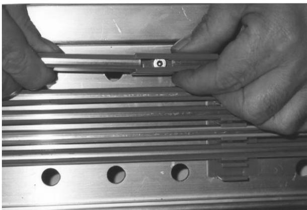
隣接するレールをレールのスリーブの両側の溝に沿ってカバーを押し込みます。両方のレールが一緒になるようにスライドさせます。
