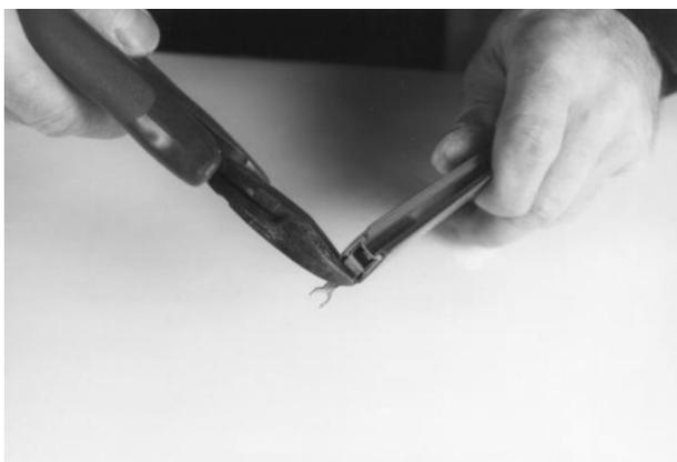
ワイヤ端子を挿入し、端子の端の長い部分を少し残して切り取るか、ハンマーで端子を少し下に叩きます。これで分離キャップは端子にかぶせてスライドできます。
