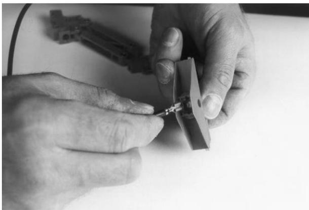
平形端子をしっかりと接続部の下に差込み、集電子ヘッドを本体に戻して止めます。
