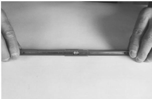
そして、2つのレールを一緒に押し込みその後締付けます。レールを取外す場合は、レールを引抜く前に接続部をもう一度緩めます。これによりコネクターのスチールプレートの変形を防止します。接続部がしっかりするようにハンガークランプはねじタイプのコネクタから 200mm 以内に設けます。
