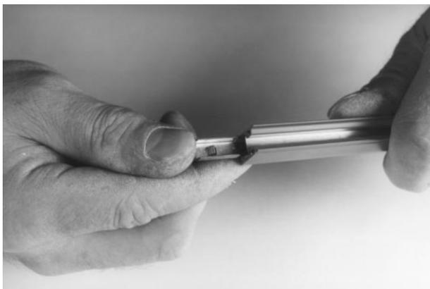
給電ワイヤが必要かどうかにかかわらず、トランスファーガイドを固く押込むようにワイヤ端子は必ず取付けます。
