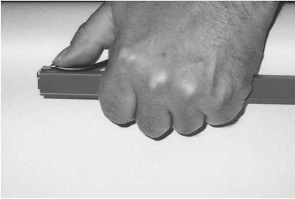
給電ワイヤ付の端子を絶縁スリーブの上になるように下に押し曲げます。これにより端子のねじれを防ぎます。
