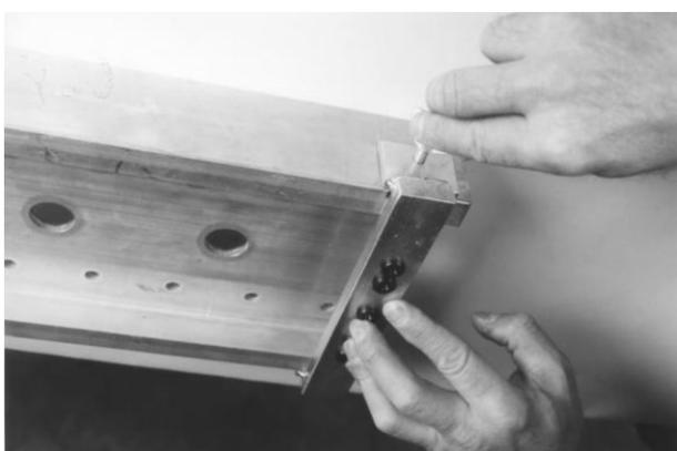
穴あけ治具の直線の端を使用してモノレールトラックの取付面に横線を引きます。
