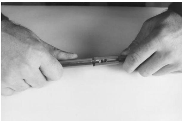
コンダクタースリーブの溝に絶縁接続カバーをストップバーに当たるまで挿入します。絶縁カバーの末端を一緒になるように押込み反対のレールをカバーに揃えます。ハンガークランプに挿入した後両方の絶縁部の縁がハウジングにより囲まれていることを確認してください。
