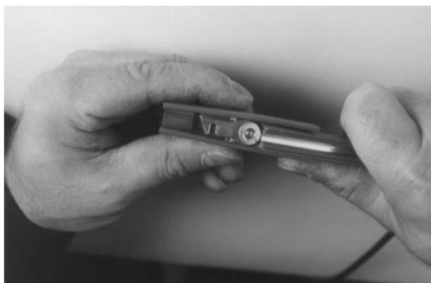
図示のようにカバーをクランプとスリーブにかぶせてカバーを中心からずれるまで押込みます。カバーの両側の縁を別々にスリーブに係合するまで押込みます。その後隣接するレールをカバーと一緒に押込み締付けます。カバーがスリーブに縁にしっかりとハマっていることを確認してください。
