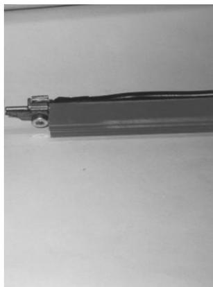
50A用給電ジョイントは高さ27mmの場合のみ使用できます。設置高さについては16ページを参照ください。図示のように給電クランプにケーブルを取付け、ねじは緩めておきます。
