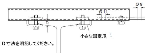
注意: ホイストホイールに十分なクリアランスがあるかを確認してください。必要なら小さな固定爪を使用してください。I形鋼のB寸法を確認してください。
