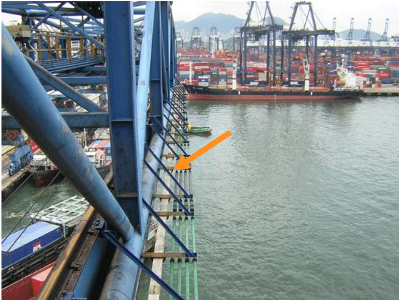
絶縁トロリー タイプ U35 データ伝送システム SMG
