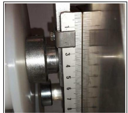
図 28: 曲げツール BVU10-VP の目盛
