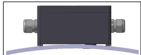
図 69: 接続ボックス、スペーサー・ブッシング取付
