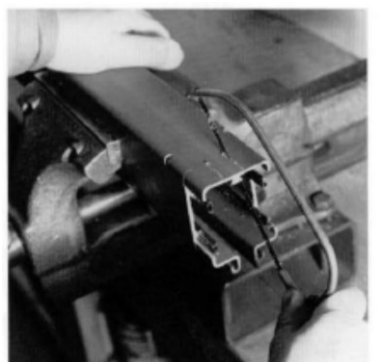
▶ 銅のサポートの両側の PVC ハウジングを 26mm のところまでのこぎりで切断します。
