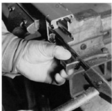
▶ 銅導体を 50mm 長さまで外側成形ツールで揃えます。
