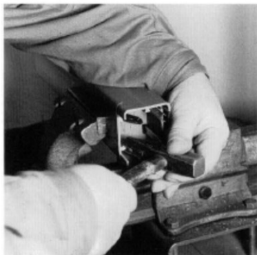
▶ 銅導体を元の位置にハンマーとペンチを使用して押し戻します。
