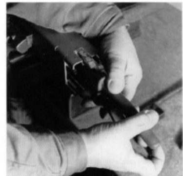
▶ 切断した PVC 部をペンチで取除きます。
